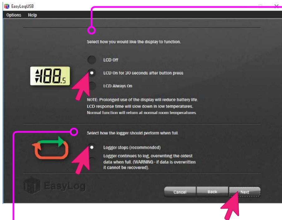
Esta función permite seleccionar el modo de funcionamiento de la pantalla LCD.
